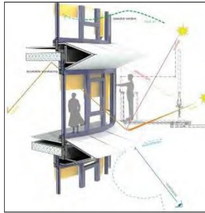
Figura 5 y 6. Detalle del Keifer Technic Showroom. Evita la reflexión de luz solar. Microclima que crea una fachada cinética.
