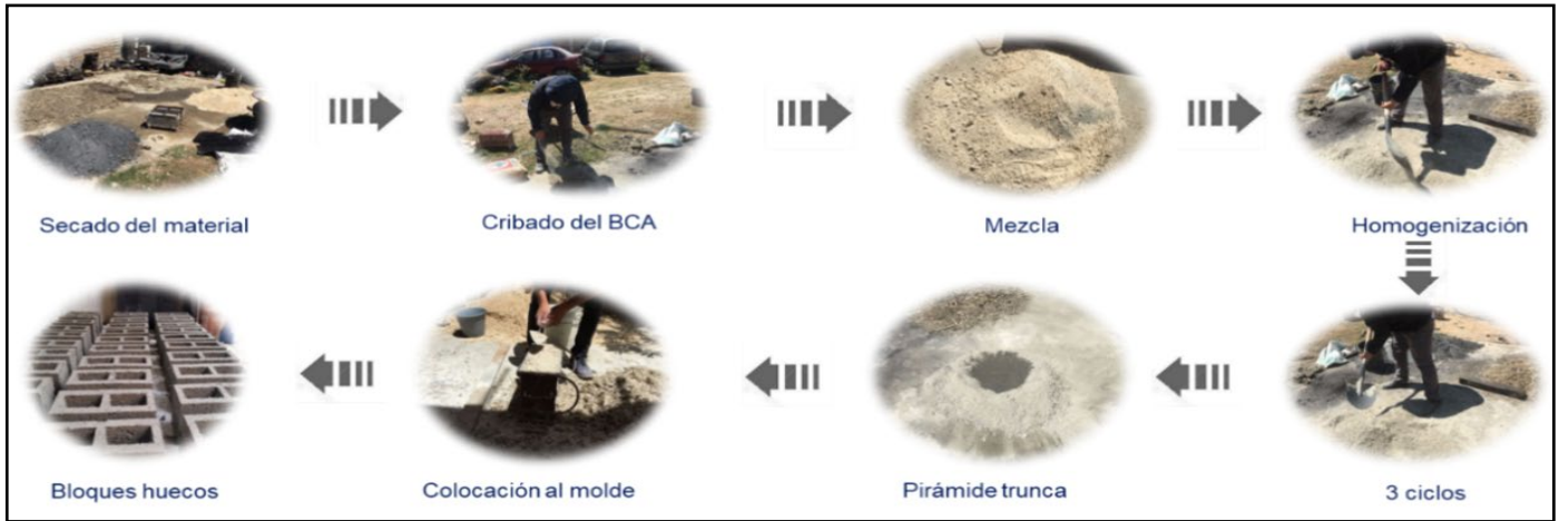
Figura 4: Proceso de fabricación de los bloques huecos de mortero cemento – arena estabilizada con BCA
