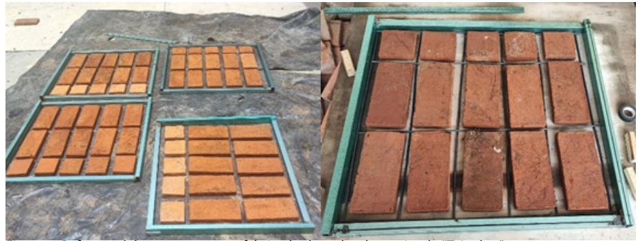
Figura 4. Refuerzo del componente prefabricado de techo denominado "Tejuelon"
