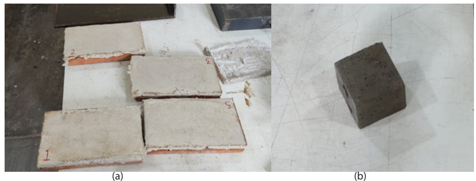
Figura 2. Componentes del componente de techado prefabricado (Tejuelón): A) ladrillo rojo cocido y B) mortero de cemento y arena.
