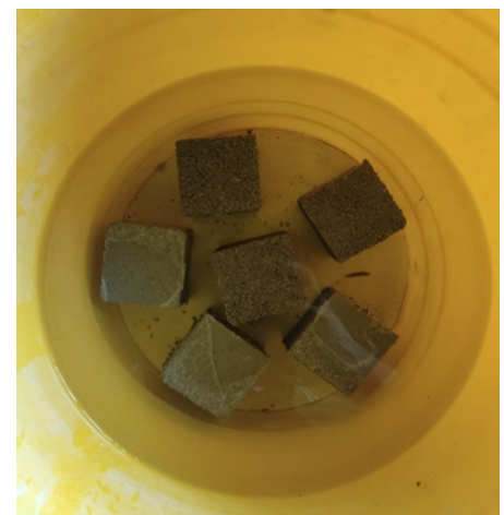
Figura 3. Especímenes sumergidos en un recipiente con agua.
