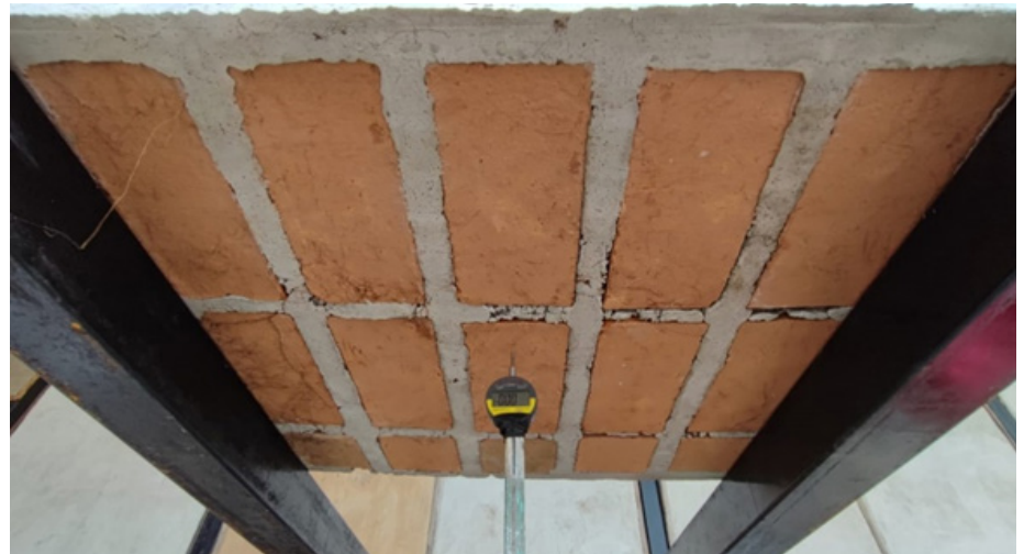
Figura 6. Colocación del extensómetro en la parte inferior central del componente de cubierta prefabricada
