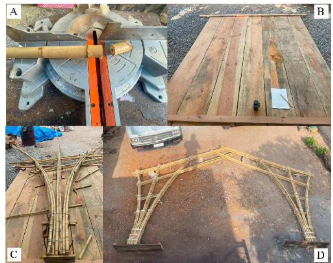
Figura 12. Proceso de fabricación de premoldeado a base de Otatea fimbriata. A) Corte de culmos, B) Superficie plana a partir de configuración de tablas, C) Armado de componente premoldeado siguiendo la silueta de forma, D) Forma final de estructura premoldeada. Nota. Fotografía tomada por los autores
