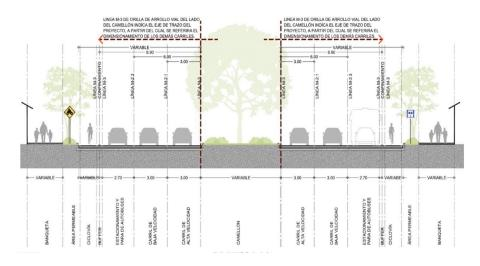
Figura 8. Sección tipo de la ciclovía de Xalapa (H. Ayuntamiento de Xalapa, Subdirección de planeación y proyectos, 2020).
